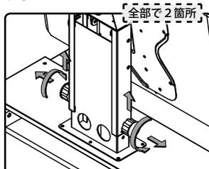
●モニターの角度をT型六角レンチで調整します。
