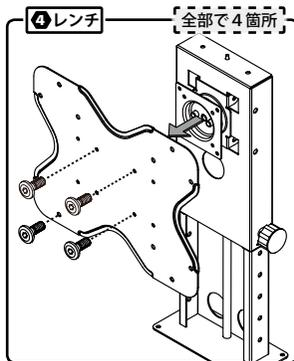
●液晶モニター用マウンターを取付けます。
